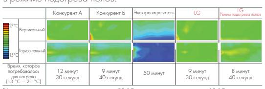
(Условия испытания: заданная температура 23 °C, температура в помещении 13 °C, температура наружного воздуха 7 °C)
